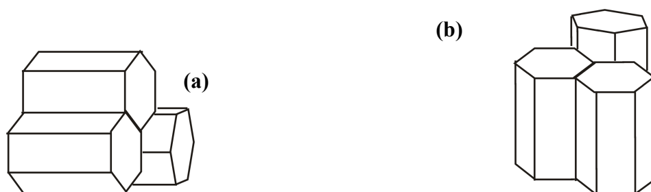
Rys. 3.1.5. Schemat przedstawiający możliwe ułożenia heksagonalnych krystalitów: (a) gdy oś c jest równoległa, (b) gdy oś c jest prostopadła do podłoża.
