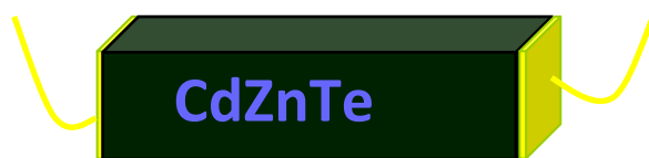
Rys. 3.8.1 Schemat próbki wraz z kontaktami wykonanymi ze złota.
