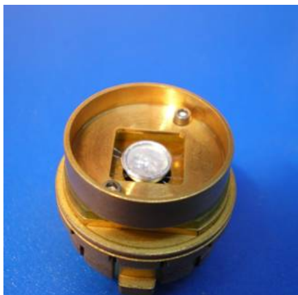
Rys. 6.5. Fotografia tygla z próbką proszkową przyklejonego do kalorymetru.
